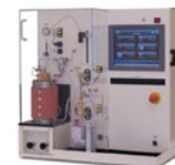
Appareil de mesure de l'encrassement des bruts.
