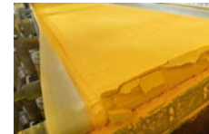
Figure 1- Photo de yellowcake sur un filtre
