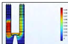
Figure 1 : Coupe de la concentration en méthane dans le four industriel
