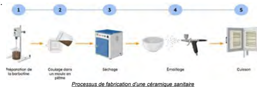
Processus de fabrication d'une céramique sanitaire
