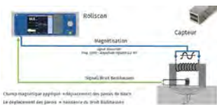
Schéma fonctionnement bruit de Barkhausen
