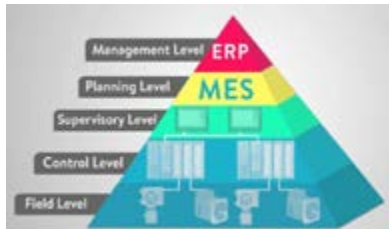
Schématisme du rôle d'un MES au sein d'une entité IT
