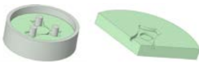
Figure 2: Géométrie du four étudié (à gauche) et domaine correspondant (à droite)
