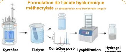
Mélange de l'acide hyaluronique avec l'anhydride méthacrylate dans un réacteur double enveloppe à 4°C suivi d'une dialyse afin de filtrer les sous-produits de réaction. Suite à cette étape, la synthèse peut être analysée en RMN afin de contrôler sa pureté et le degré de méthacrylation. Une étape de lyophilisation est ensuite nécessaire pour pouvoir utiliser l'HAMA.
